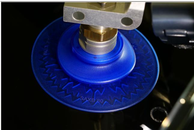
Ventouses à soufflets SAXB pour la manipulation de pièces de tôle moulées
